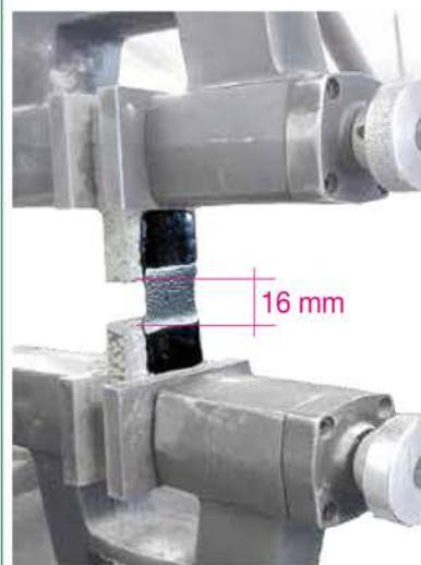
Испытание на растяжение при проявлении трещин.
